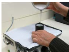
Einbettmasse einfließen lassen
