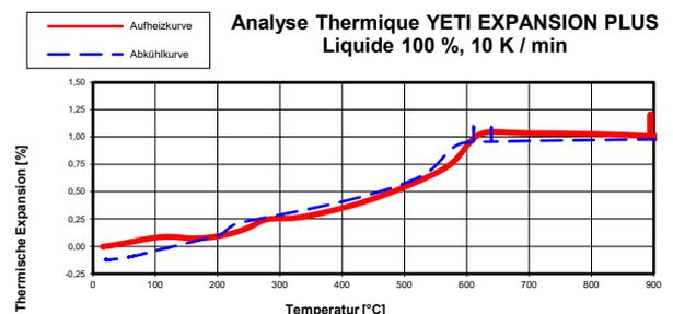
**YETI Expansion Plus se distingue à travers une possibilité d'obtention maximale d'Expansion. Apte pour tous les alliages précieux et céramique pressée.**
